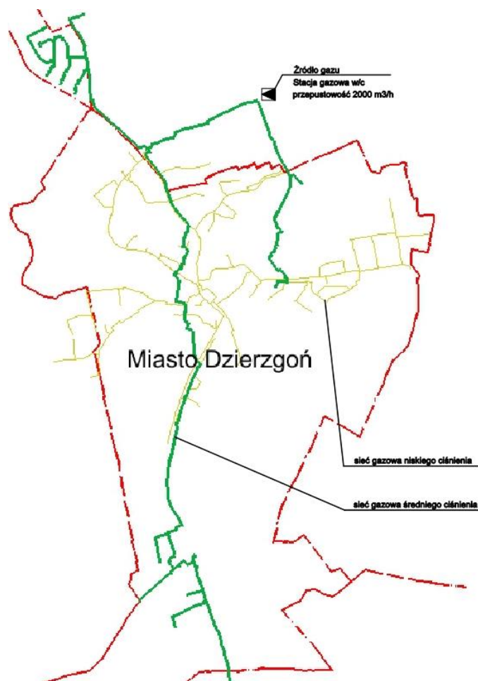
Ryc. 7. Schemat sieci gazowej na terenie miasta Dzierzgoń Źródło: Polska Spółka Gazownictwa Sp. z o.o. Oddział Gdańsk
