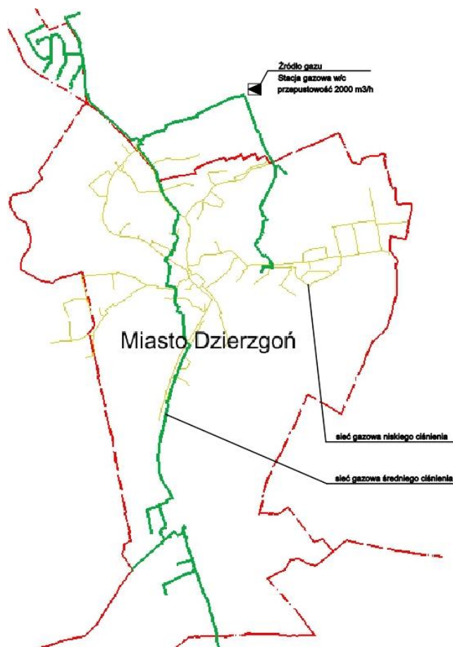
Ryc. 6. Schemat sieci gazowej na terenie miasta Dzierzgoń
